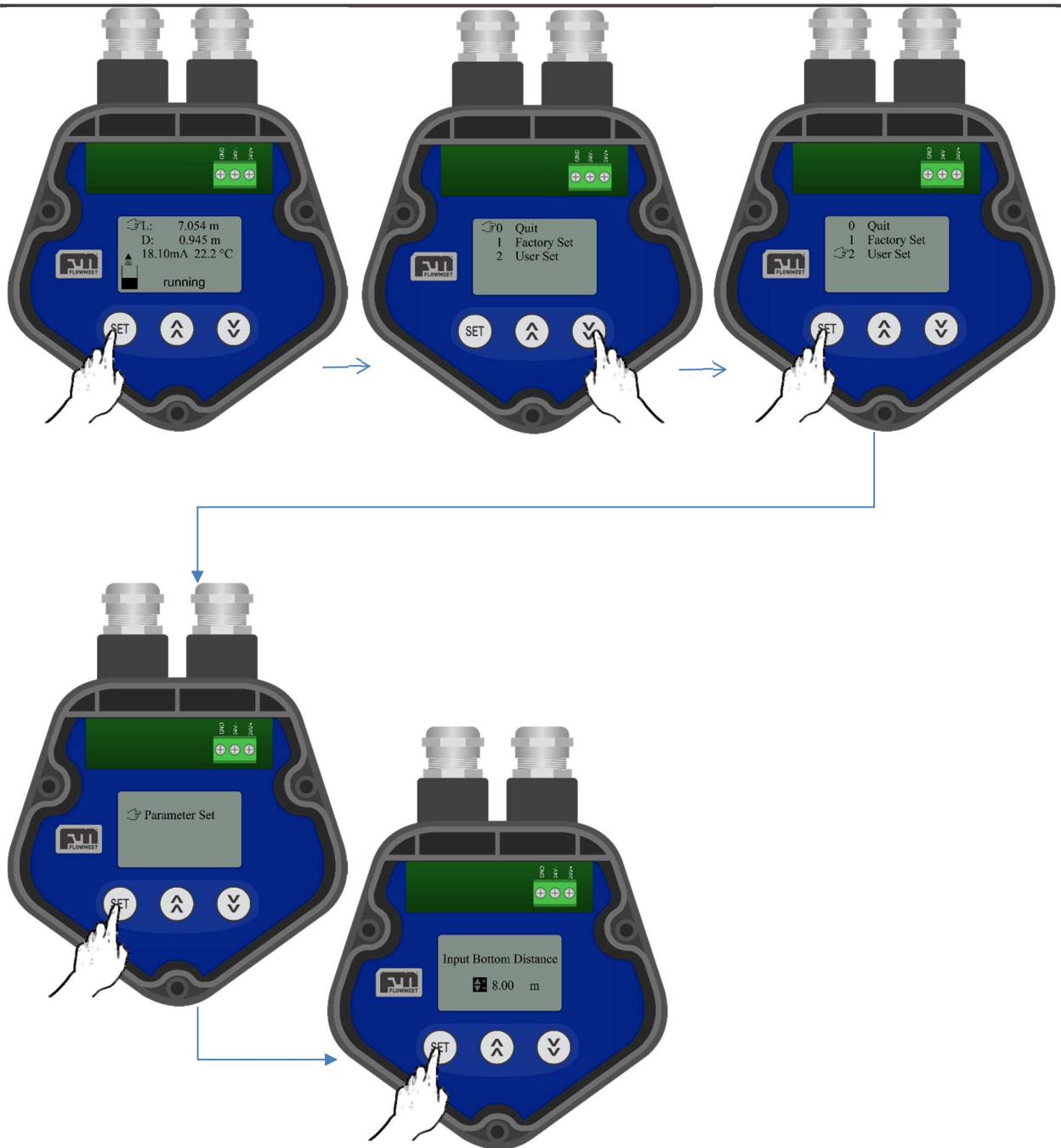
Figura 1.3 Programación de altura del tanque H
